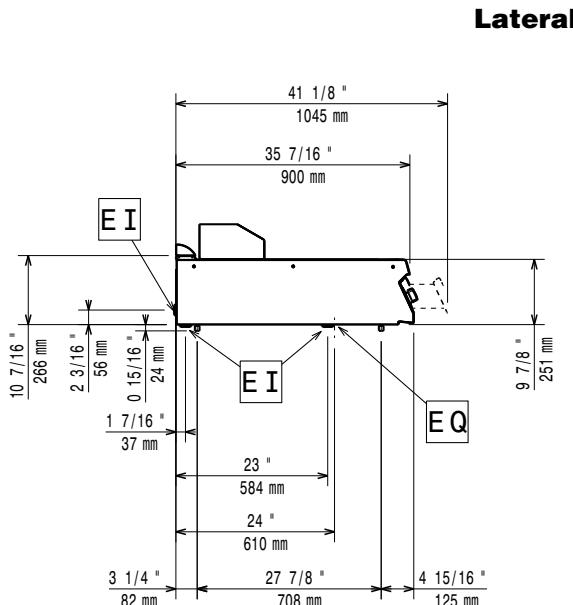
EI = Conexión eléctrica (energía)
